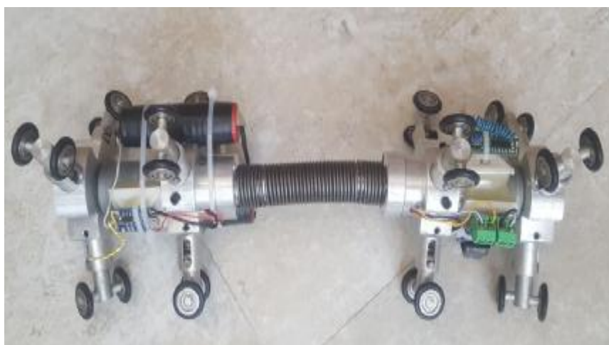
شکل 8- ربات ماژولار ساخته شده برای حرکت در داخل خطوط لوله گاز طبیعی شهری
