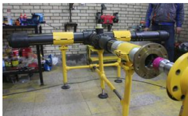
شکل 8- دستگاه ساخته شده برای انشعاب گیری از لوله های پلی اتیلنی با سایز 125 میلیمتری و بالاتر بدون قطع گاز و ست آپ ساخته شده برای تست
